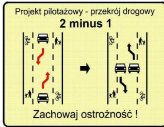
Ilustracja 42: Projekt pilotażowy: Zasada poruszania się pojazdów na drodze o przekroju drogowym "2 minus 1".
